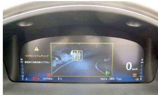
Figure 14 : Aperçu du système Night View de Toyota qui permet une détection rapide des piétons en vision nocturne.
